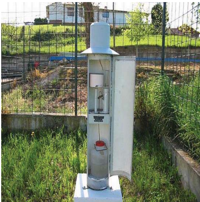
Figura 26. Pluviógrafo de sifón para medir intensidad, duración y frecuencia de las lluvias.
